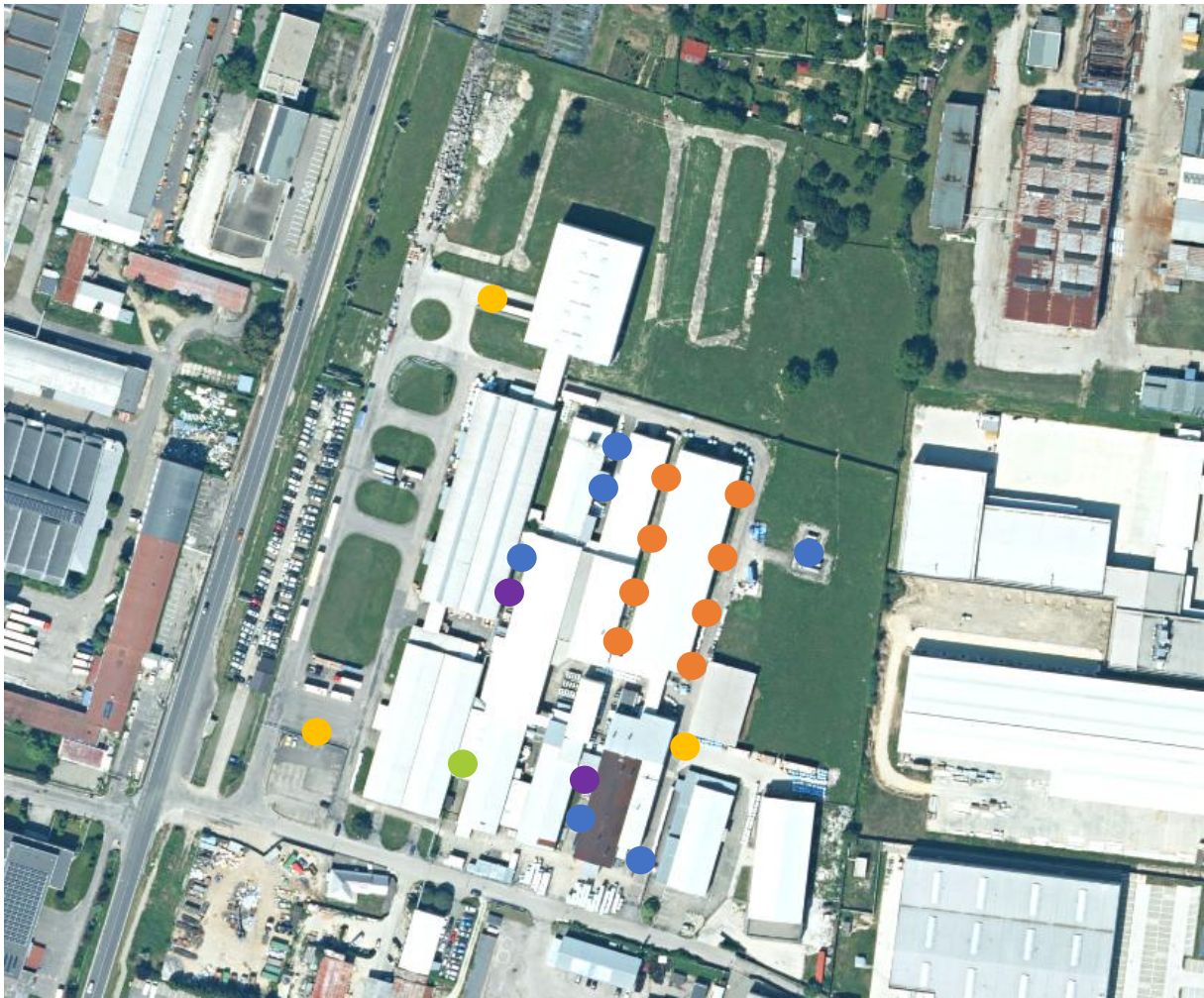
OBR. 9 Dispozícia umiestnenia zdrojov zvuku v areáli prevádzky: žltými bodmi sú vyznačené miesta pre vykladanie a nakladanie tovaru z/do nákladných vozidiel, zelený bod – otvorená brána do výrobnjej haly, modré body – čerpadlá, oranžové body – výduchy, fialové body – chladiace jednotky
