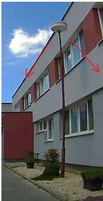
Obr. 18 Nevhodné umiestnenie svietidla na osvetlenie chodníka – Vnútrobloky
