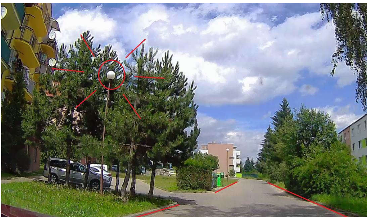
Obr. 19 Svetidlo typu „Globe“ – svetidlo nesvietí na miesto, kam by malo
